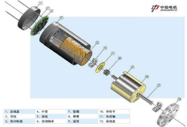
图表 25: 无刷空心杯电机结构图
